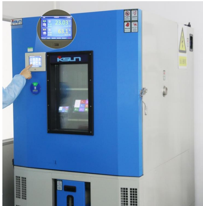
图 4-7 高低温老化测试图
